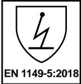
Ausführungen für elektrostatisch ableitfähige Schutzkleidung, die Bestandteil eines vollständig geerdeten Systems zur Vermeidung von zündfähigen Entladungen ist. In brennbaren Atmosphären, die mit Sauerstoff angereichert sind, können die Anforderungen möglicherweise nicht genügen. Diese Bekleidung gilt nicht für den Schutz vor Netzspannungen.
