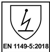
vêtements de protection à dissipation électrostatique qui font partie d'un système entièrement mis à la terre afin d'éviter les décharges inflammables. Dans des atmosphères inflammables enrichies en oxygène, il se peut que les exigences ne soient pas suffisantes. Ce vêtement n'est pas adapté pour la protection contre les tensions de réseau d'alimentation électrique.
